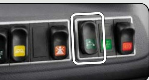
Zur Anpassung der Fahrgeschwindigkeit an die Einsatzbedingungen ist am Armaturenbrett ein Schalter vorhanden, der folgende Wahlmöglichkeiten zulässt :
