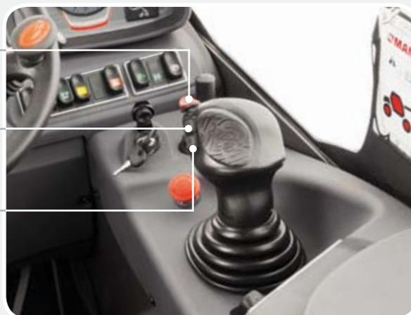
Mit dem JSM werden alle Teleskopfunktionen proportional und unabhängig voneinander angesteuert, so dass die Vorgänge beschleunigt werden.
