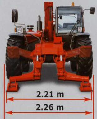
Proportionale Stabilisatoren mit individueller oder simultaner Steuerung, die sich auf einer Breite von 2.21 m absenken. Die Maschine stützt sich innerhalb ihrer eigenen Kontour ab, was ideal für Renovierungsarbeiten ist.
