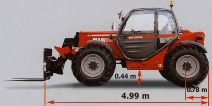
Die Gesamtlänge von unter **5 m** und der geringe Überstand hinten sorgen für die Kompaktheit und die Manövrierbarkeit, die auf engen Baustellen erforderlich ist. Der Wenderadius von **3.75 m** ermöglicht problemloses rangieren auf Baustellen mit eingeschränkten Platzverhältnissen.
